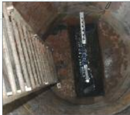
使用 SPEEDY 和 dBS6 在水渠内X面积速度测流法
