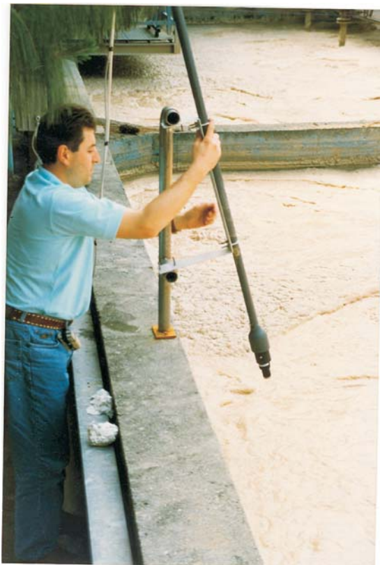
自清洗沉入探头的典型安装
