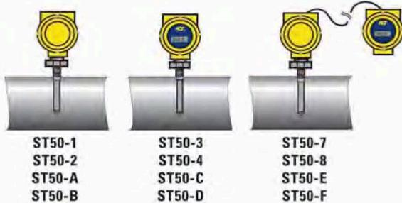
为了便于接线和信号隔离，ST50 封装带有双电气接口（NPT 或 M20 螺纹），且前后盖可取下。ST50 适用于 DC（18V~36V）或 AC（85V~265V）电源。
